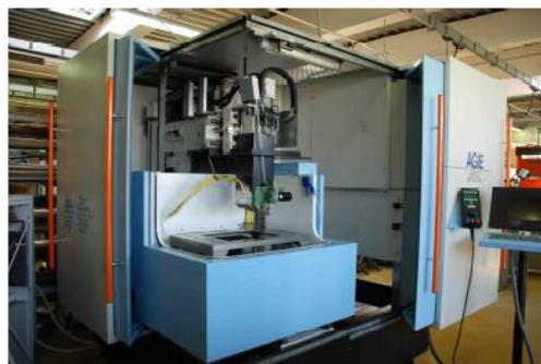
Machine Electro-Erosion à fil (2010)
