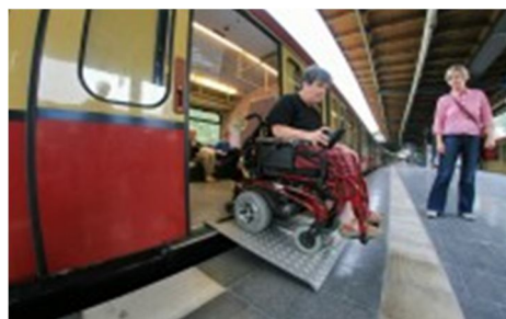
Rampes manuelles et électriques mises en place pour faciliter la montée et la descente des PMR à bord des TC
