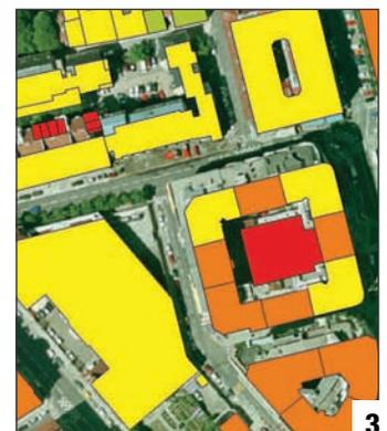
1. image visible - 2. image thermique - 3. carte thermique des bâtiments : en vert, faible déperdition, en rouge : forte déperdition.
