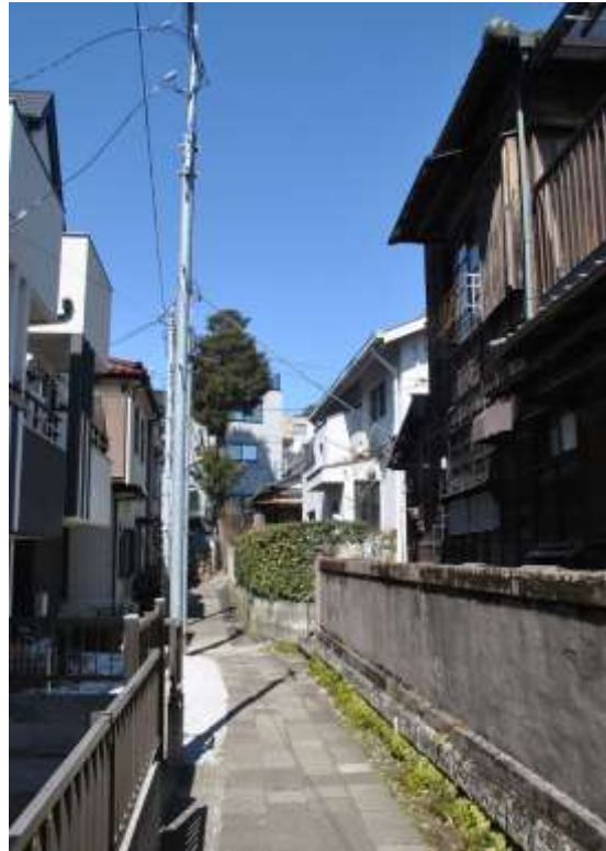
Les rues du quartier Sengaku-ji à Tanakawa sont très étroites, souvent moins de 2 m. Le Plan de Tokyo impose le recul du bâti sur l'alignement d'au moins 1 m (à gauche).
