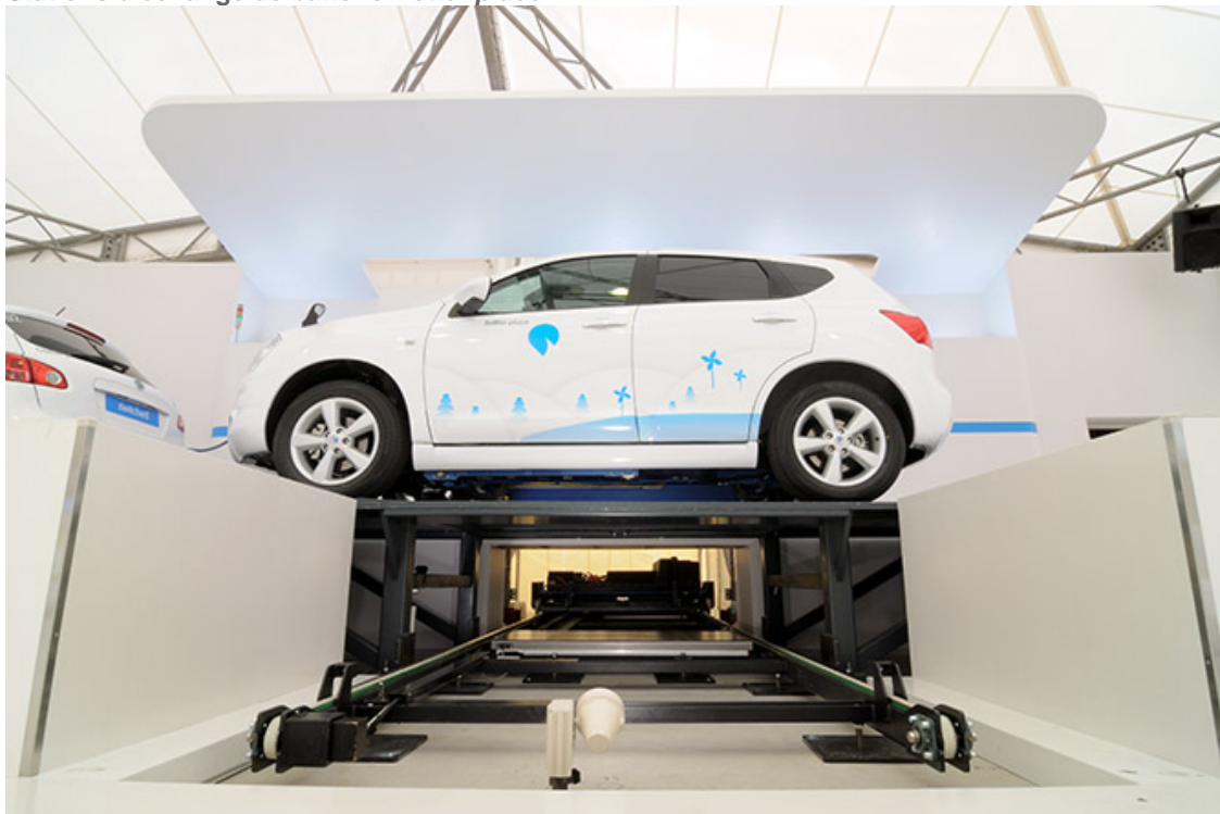
Stations d'échange de batterie Better place
