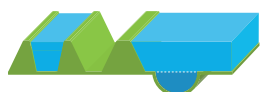
Canal de dérivation Un canal est creusé entre deux digues, créant une nouvelle voie d'évacuation pour les hautes eaux.
