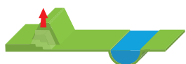
Renforcement des digues Les digues sont renforcées à certains emplacements où le programme RVR n'est pas adapté.
