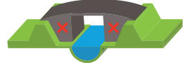
Suppression des obstacles Les « obstacles » sont supprimés ou réaménagés pour assurer un écoulement plus rapide de la rivière.
