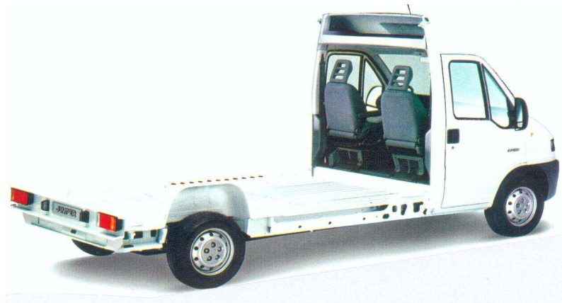
Citroën Jumper version plancher-cabine en attente de carrosserie
