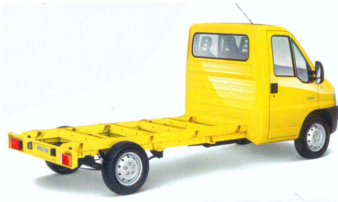
Citroën Jumper version châssis-cabine en attente de carrosserie avec cabine fermée et longerons renforçant le châssis
