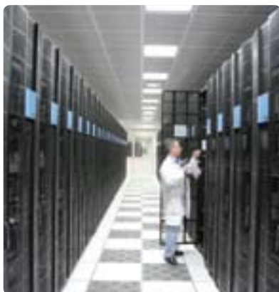
Le supercalculateur Tera-10, qui développe une puissance de plus de 50 téraflops (50 000 milliards d'opérations à la seconde).
