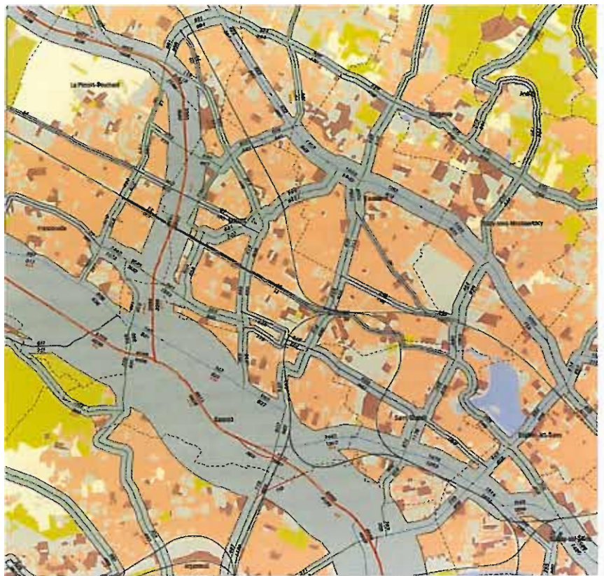
Représentation cartographique des flux de trafic routier (situation actuelle en heure de pointe du soir) aux environs des communes d'Ermont et Eaubonne (Val d'Oise). Ces flux sont obtenus par calcul à partir du modèle global de prévision de trafic de l'AURIF
