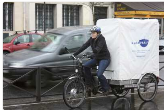
Vélo utilisé pour les mesures de l'exposition des cyclistes. Airparif
