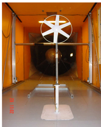
LMF : Essais en Soufflerie de petites éolienne dans la veine principale (max. 40 m/s) et la veine retour (max. 10 m/s)
