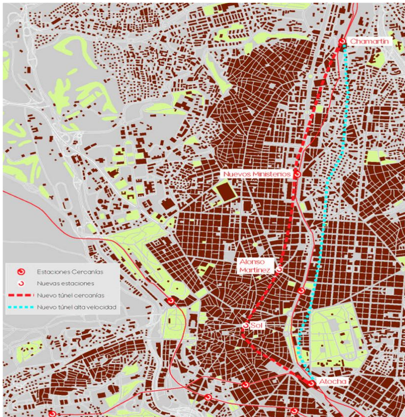
Plan des deux projets de tunnel (en pointillé rouge celui des trains de banlieue, en bleu celui de l'AVE)
