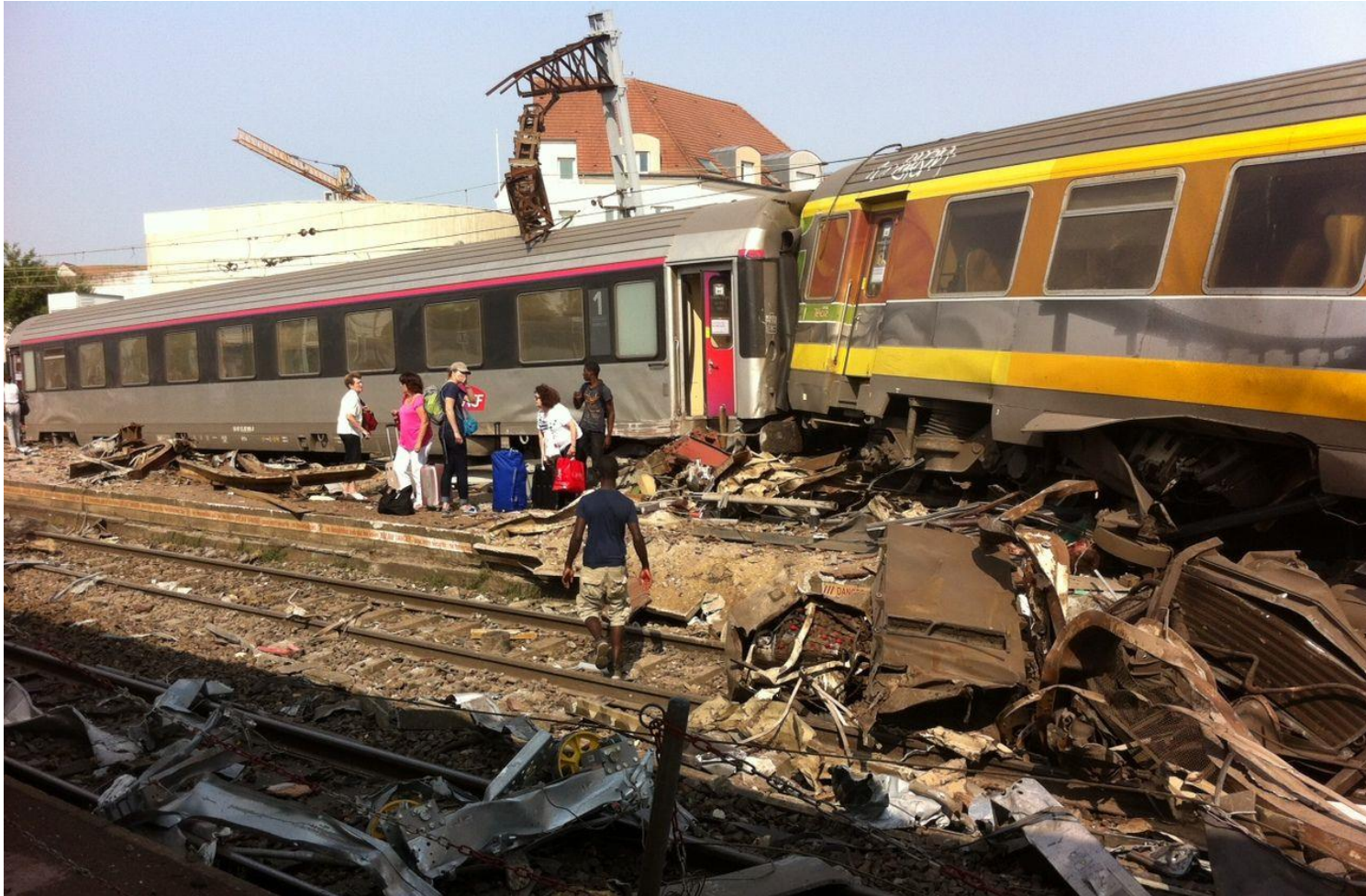
Accident de Brétigny-sur-Orge, 2013. Manque d'entretien du réseau mis en cause
