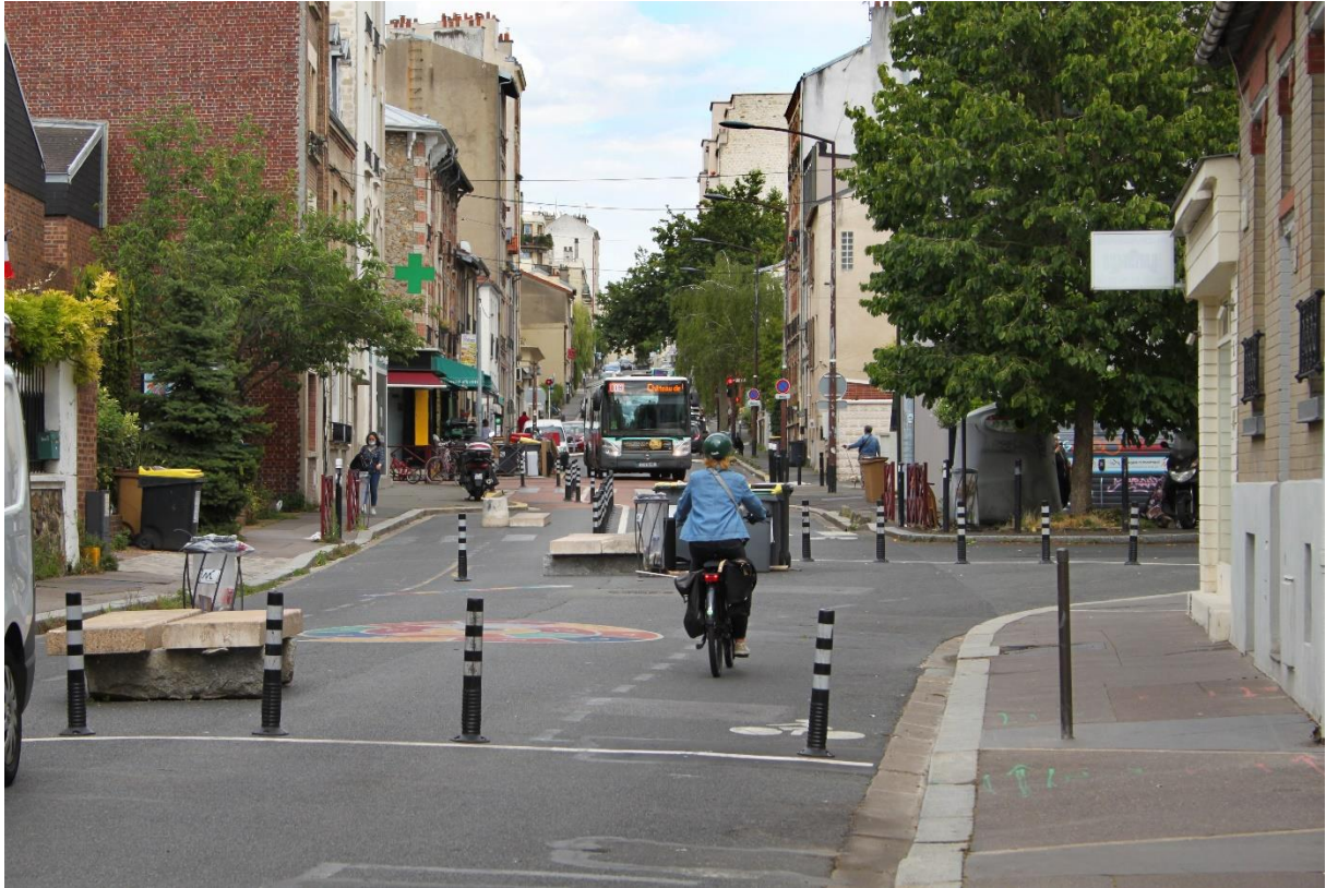
Figure 26 : l'un des filtres modaux installé dans le quartier Solidarité-Carnot à Montreuil. Crédit : Maximilian Gawlik, L'Institut Paris Region.
