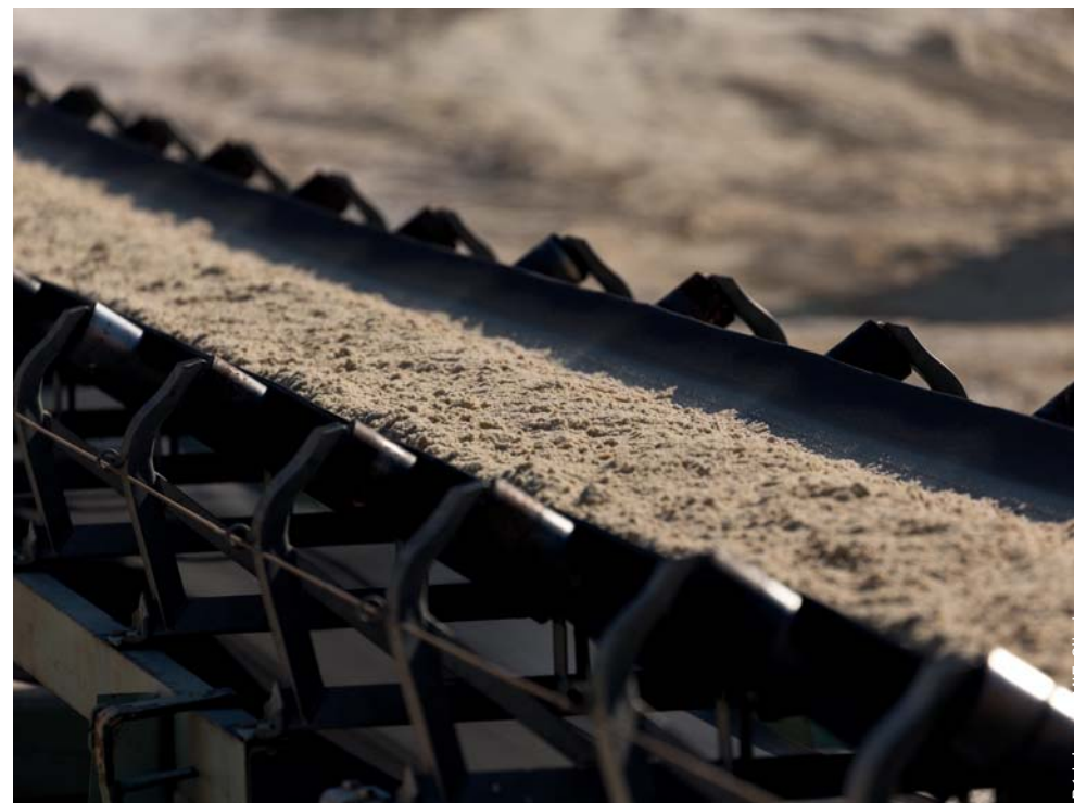
▲ Bande transporteuse de sables siliceux.
