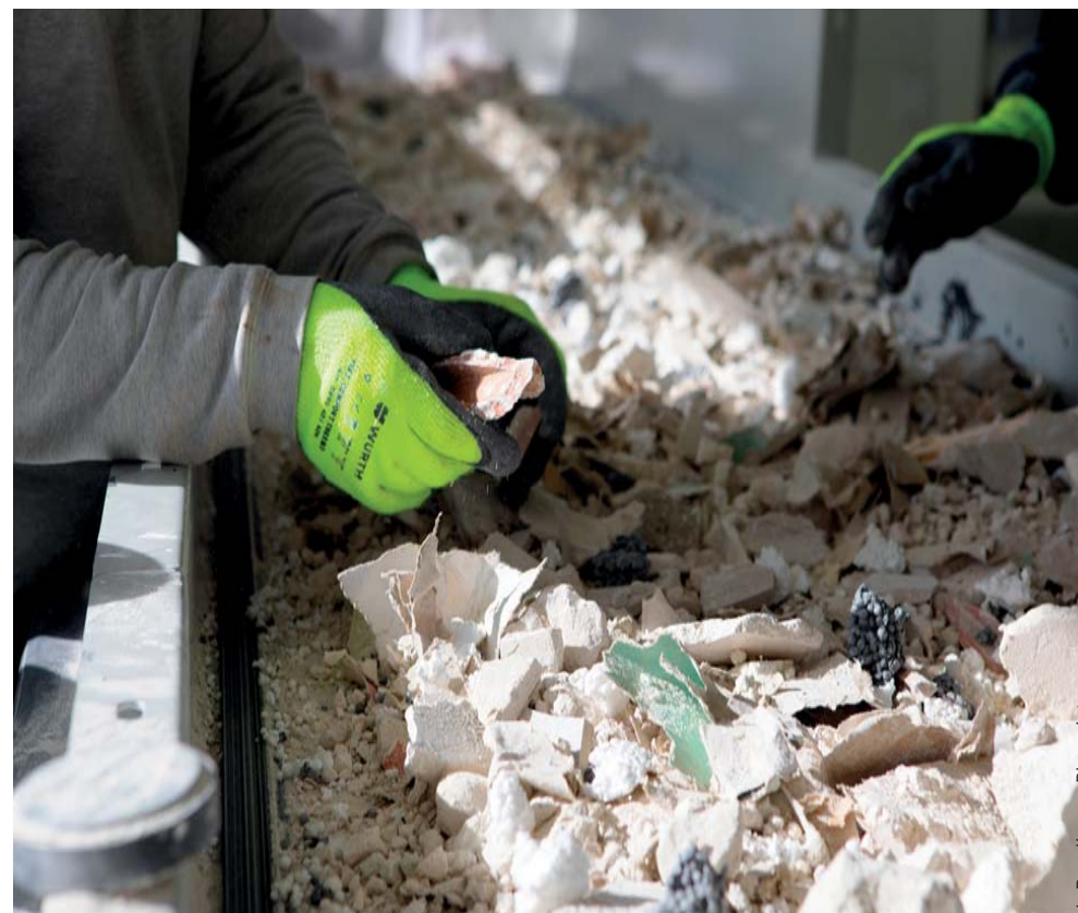
▲ Opération de tri pour le recyclage du plâtre.
